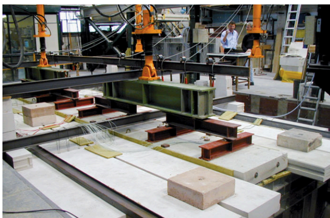
Bild 8. Darstellung der Versuchskörper und der Übertragbarkeit der Versuche auf Flächentragwerke Fig. 8. Single span test slabs and the transfer to two-way spanning slabs
