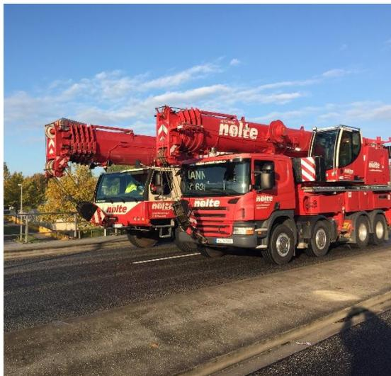
Bild 13 (links): Belastungsversuch Kranüberfahrt (60 to + 40 to)
